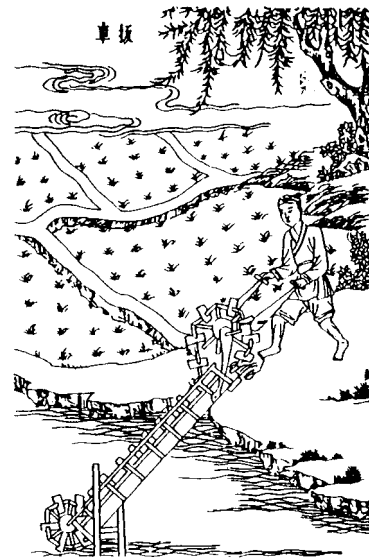
Fig. 5 Ba Che (hand-rocked lift) 4)
