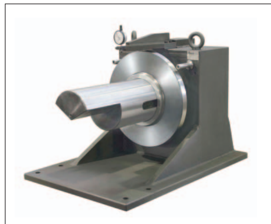
図10 軸受組立て肉厚測定器
