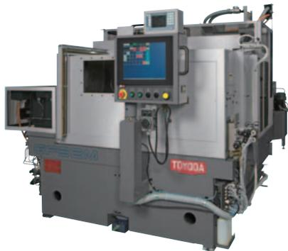
エンジンの主要部品であるクランクシャフトのピン部をシングルヘッドといし台で加工する CBN といし専用小型 C-X クランクピン研削盤である。といし台送りにリニアモータを採用し自社開発の高速 CNC 「GC50」を搭載することにより、といし台の運動と工作物の回転の同期によるピン部創成研削を高い精度で実現した。
