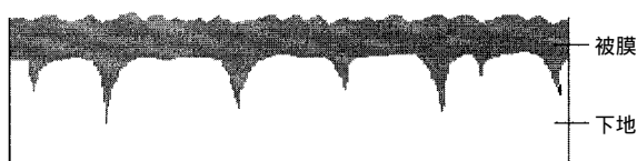
図1 りん酸マンガンを被膜表面
