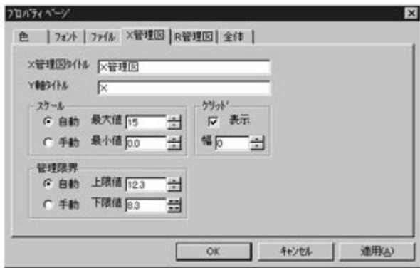
図11 X管理図系の設定画面 Property box for X control chart
