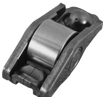
図14 静強度試験後のロッカアーム
