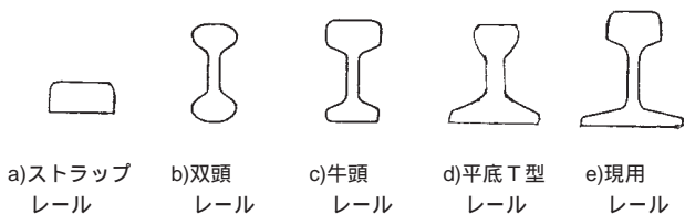
図8 レール断面形状の変遷 Transition of cross section of rails
