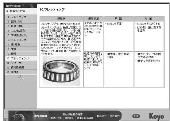
損傷例と対策の一例
