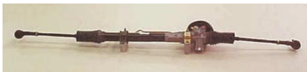
ラック&ピニオン式パワーステアリング
