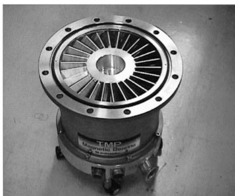
図 11 ターボ分子ポンプ(2 000 ℓ/sec クラス) Turbo Molecular Pump(2 000 ℓ/sec class)
