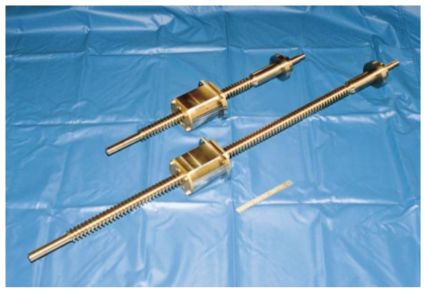
図16 静圧ねじねじ: SUS製, ナット: アルマイト処理アルミ製) Hydrostatic screw
