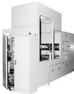
光洋リンドバーグ株式会社では、ハードディスク表面熱処理装置を商品化しているが、ディスクの小型化、大容量化、歩留まりの向上が期待されている。今回新しい設計思想で、カセットレス加熱、ハイクリーンをコンセプトに、独自の回転搬送システムで高精度の加熱処理を可能とした、最新の装置を開発した。
