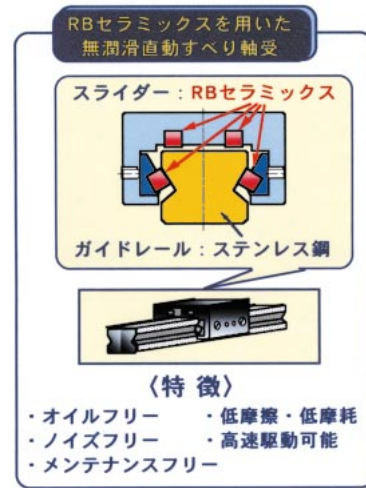
図6 RBセラミックスを用いた無潤滑直動すべり軸受の概要
