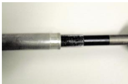
図9 シャフトへの樹脂コーティング Resin coating on the shaft
