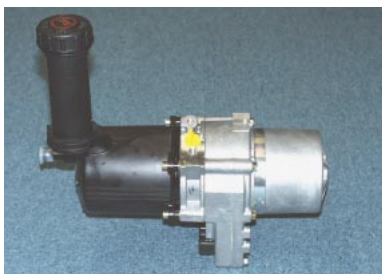
電動ポンプ (ECU一体型直流ブラシレスモータ採用)
