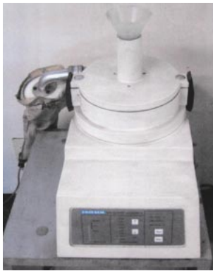
図3 ロータースピードミル Rotor speed mill
