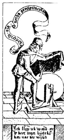
図7 足踏み式の砥石車(1485年・Schroeder) 6) Grinding wheel with treadle, 1485. 6)
