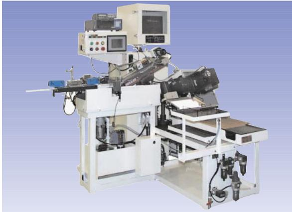
円筒部品加工後の外径寸法および外径の欠陥を検査するシステム。
