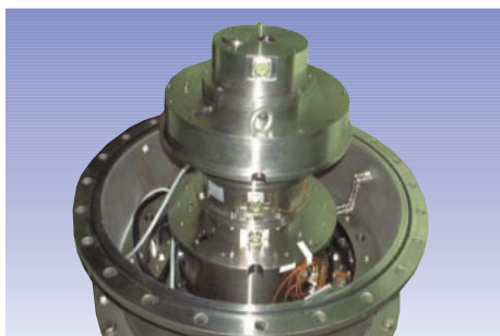
1 kWh級フライホイール電力貯蔵システム
