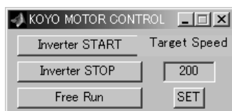
図16 インバータ制御用ダイアログボックス Dialogue box for controlling motor drive
