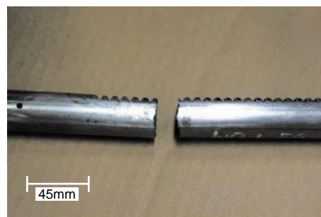
図1 二分割に破断したラックバー Rack bar in breakage mode of fracture
