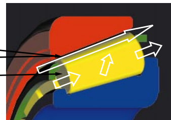
軸受内部の油の流れ
