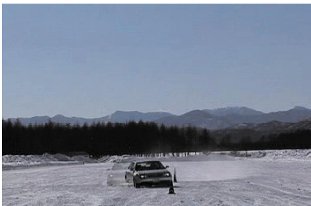
図11 車両姿勢制御用SBW-D*制御による 寒冷地試験
