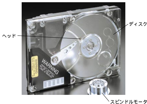
図1 HDD装置 HDD
