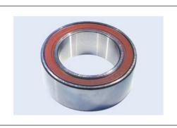
カーエアコン用コンプレッサの電磁クラッチ部に組み込まれる密封式複列アンギュラ玉軸受であり,コンパクト性,高速性,耐熱性,耐水性,耐じん性等が要求される.
