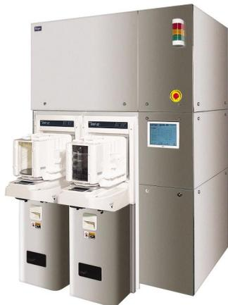
めまぐるしく変化する市場ニーズに迅速な対応が要求される半導体製造装置の分野において、中国経済産業局の新規産業創造技術開発費補助金のもとに、当社は三井造船株式会社と共同で、従来の抵抗加熱ヒータに代わり革新的誘導加熱システムを適用し、高速性、均一性に優れた新しいコンセプトの枚葉型半導体高速熱処理装置を開発しました。誘導加熱システムの採用で、小熱容量の加熱チューブを高速加熱し、この熱で間接的にシリコンウエハを  $1000 \pm 1$  に急速かつ均熱に加熱制御するものです。これにより半導体製造分野における製品の品質化、製造コストの低減に貢献できます。
