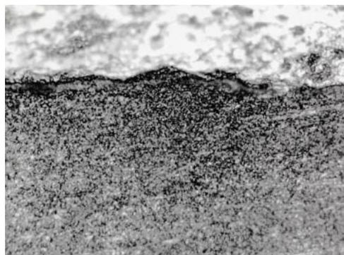
図10 試験後のWC溶射断面組織
