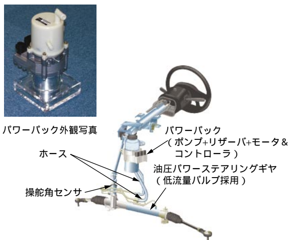
図1 H-EPSシステム構成
