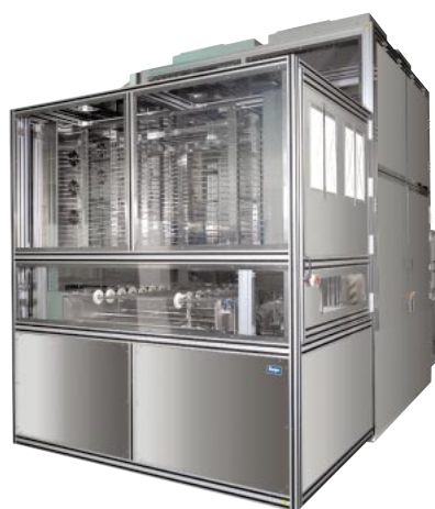
図6 第4世代以降基板対応クリーンバッチシステム(CCBSシリーズ)
