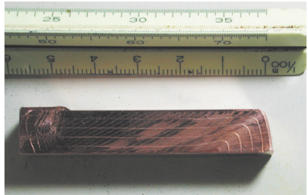
図8 曲がり角が直角、アール無しのダイスによる1回パス後の銅 罫書き線の模様から中央部分ではほぼ理想的な単純せん断変形が達成されていることがわかる。
