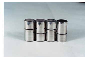
図11 ころ転動面 Rolling surface of roller
