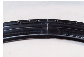
図10 軌道分割部 Raceway split section
