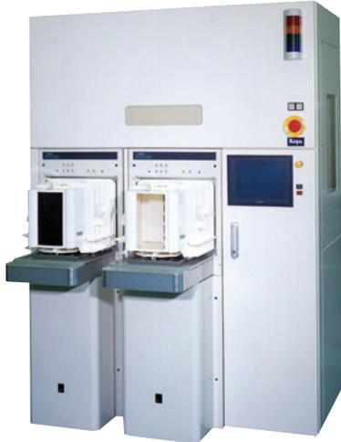
大口径化・微細化が進む半導体業界において、日本国内の 300mm ラインも本格化してきた今、当社では長年にわたる経験を踏まえ 300mm 対応のランプアニール装置「RLA-3300」を開発しました。ランプアニール装置は雰囲気加熱ではなく、ハロゲンランプからの光エネルギーをウエハが吸収し温度を上げる仕組みであるため、昇温 250 / s・降温 90 / s という高速な熱処理が可能です。また、高速温度制御システムの採用や、独自のクロスランプ構造およびランプ配分(ゾーン構成)の細分化によるウエハ面内の均一化を向上し、多岐にわたる顧客の要求に応じていきます。
