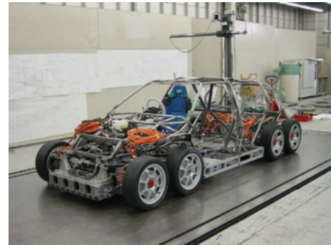
図5 アッパーフレーム装着時 Integrated platform with upper frame
