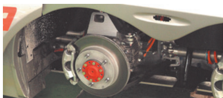
図5 車に搭載されたインホイールモータ In-wheel motor mounted on vehicle
